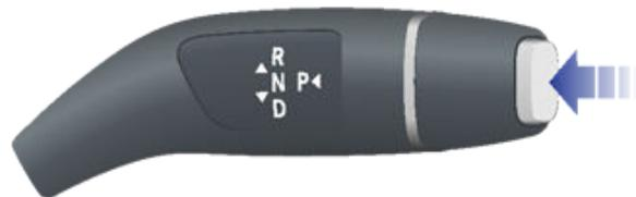
Model S passe automatiquement en mode P (stationnement) lorsque vous connectez un câble de recharge ou si au moins deux des conditions suivantes sont réunies simultanément : 2 km/h :
