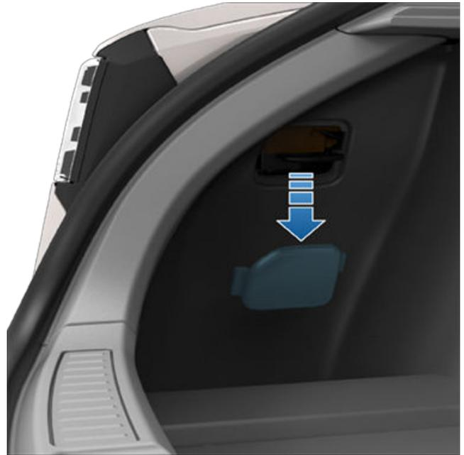
4. Poussez le levier de dégagement manuel de la prise de recharge vers l'avant du véhicule et maintenez-le dans cette position pour déverrouiller le câble de recharge.
