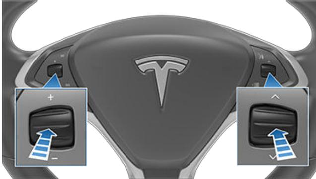
3. Au bout de quelques secondes, le logo Tesla apparaît. Attendez environ 30 secondes que l'écran tactile redémarre. Si l'écran tactile ne répond toujours pas ou si son comportement reste inhabituel au bout de quelques minutes, essayez de mettre le véhicule hors tension, puis de nouveau sous tension. Voir [Mise hors tension, puis sous tension du véhicule](#).
