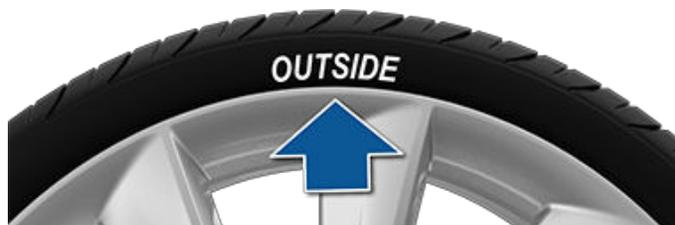
**⚠ AVERTISSEMENT :** La tenue de route est sérieusement compromise si les pneus ne sont pas bien montés sur les roues.
