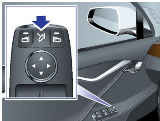
Le rétroviseur latéral du conducteur s'assombrit automatiquement la nuit en fonction du degré d'éblouissement des phares d'un véhicule derrière vous (sauf en marche arrière). Par ailleurs, les deux rétroviseurs extérieurs latéraux sont équipés de chauffages qui s'activent et se désactivent avec le dégivrage arrière.
