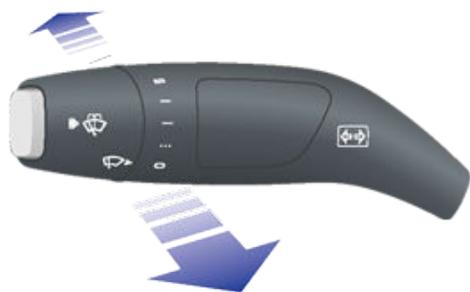
Les feux de route peuvent passer automatiquement en feux de croisement lorsqu'une source de lumière est détectée devant votre Model S (telle que les feux d'un véhicule). Pour activer ou désactiver cette fonctionnalité, appuyez sur **Contrôles > Contrôles rapides > FEUX DE ROUTE AUTOMATIQUES** ou **Contrôles > Feux > FEUX DE ROUTE AUTOMATIQUES**.
