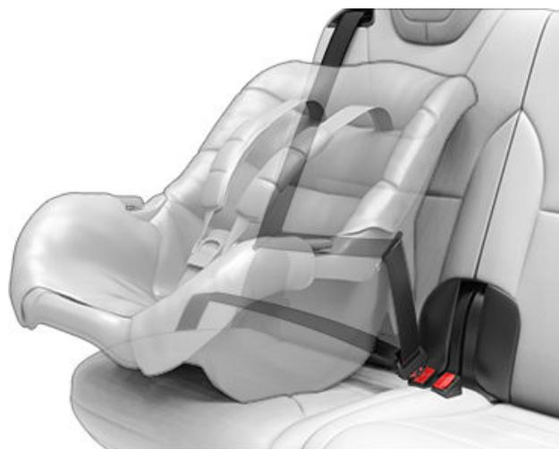
2. Laissez la ceinture de sécurité s'enrouler, et éliminez le jeu de la ceinture de sécurité tout en poussant fermement le siège de sécurité pour enfant dans le siège de la Model S.
