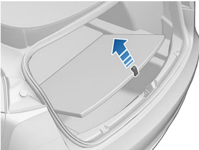
**ATTENTION :** Ne placez jamais de charges supérieures à 130 lbs (60 kg) dans le compartiment de coffre supérieur ou supérieures à 285 lbs (130 kg) dans le compartiment de coffre inférieur. Ceci risque d'entraîner des dommages.
