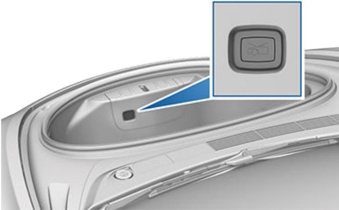
Appuyez sur le bouton de déverrouillage intérieur pour ouvrir le coffre avant puis levez le capot.
