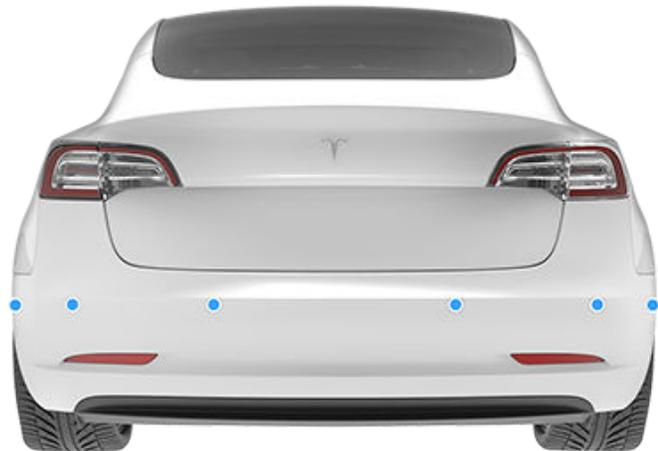
Les capteurs sont activés si vous conduisez à une vitesse inférieure à 8 km/h.
