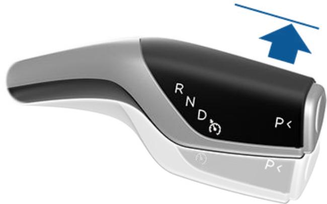
Pour réactiver le régulateur à la vitesse de conduite actuelle, abaissez complètement le levier de vitesses une fois avant de le relâcher.
