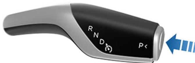
Model 3 passe automatiquement en mode P (stationnement) lorsque vous connectez un câble de recharge ou si au moins deux des conditions suivantes sont réunies simultanément : 2 km/h :
