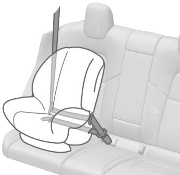
2. Laissez la ceinture de sécurité s'enrouler, puis faites en sorte qu'il n'y ait pas de jeu avec la ceinture de sécurité tout en poussant fermement le dispositif de retenue pour enfants dans le siège du véhicule.
